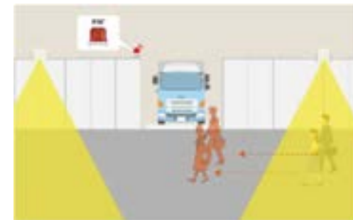
車両検知警報装置
