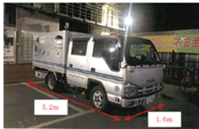
路面下空洞探査車(車載型レーダー)
